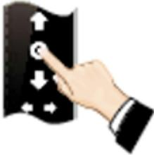
Schalten Sie den Motor ein, drücken Sie „STOP“ auf dem Programmsender für 5 s. Der Motor befindet sich 30 Sekunden lang im Programmiermodus.
